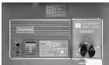
Dimmer a bordo dell' illuminatore
